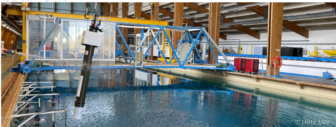
Tests des flotteurs profileurs BGC-Argo au bassin Ifremer (Brest)
